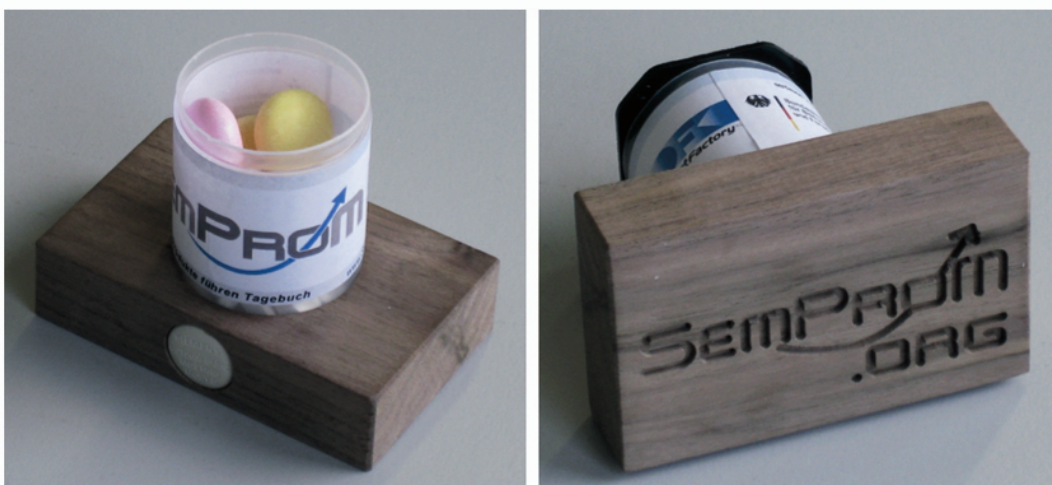
Bild 3: Die „smarte Medikamentendose“ besteht aus einem hölzernen Träger (mit MDS D160 Transponder und Projektlogo auf der Unterseite) und einer mit Medikamenten gefüllten Plastikdose
